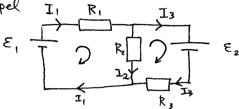
Finn strømmen gjennom  $R_1$  uttrykt ved  $E_1, E_2, R_1, R_2, R_3$ .
